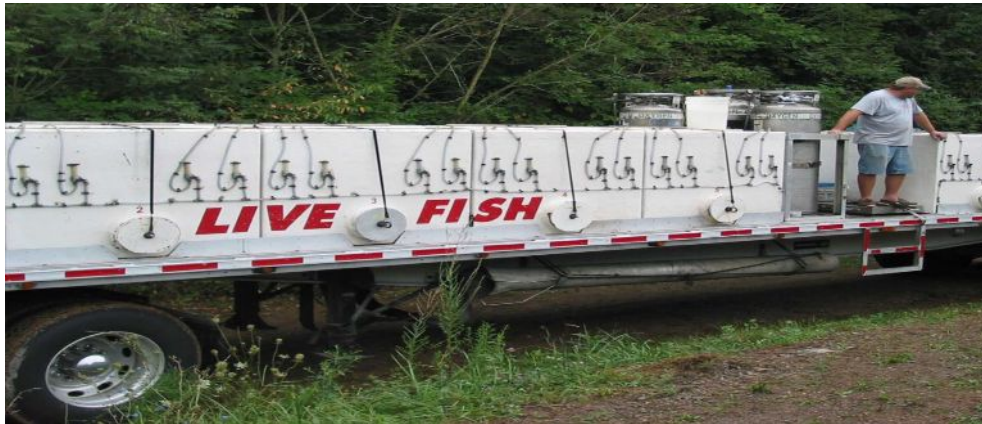
Фиг. 2: Камион с полу - ремарке, натоварено с резервоари и бутилки за кислород.
